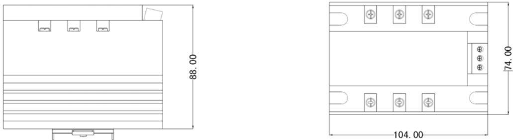
60A(5.5KW)、80A(7.5KW)外形尺寸图 单位:mm
